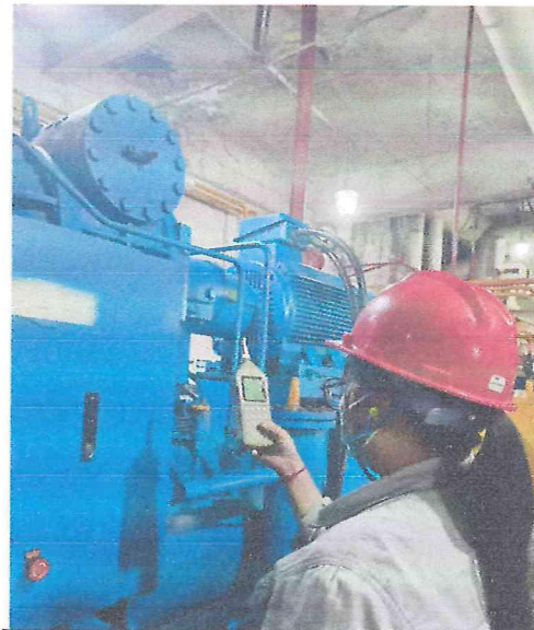
2023.11.17 螺杆制冷压缩机噪声检测
