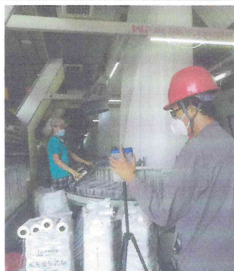
2023.11.7 圆织机操作位粉尘检测
