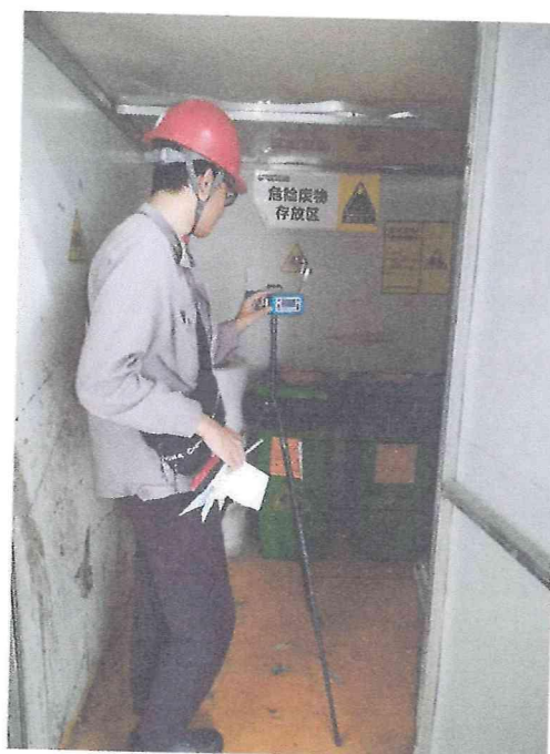
危废间毒物检测
