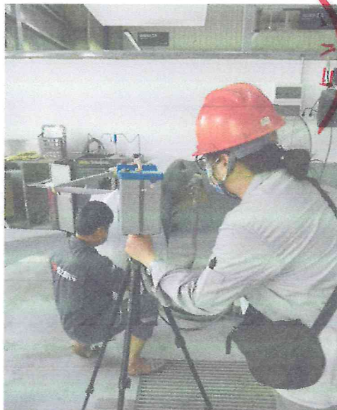
2023.9.8 打磨操作位粉尘检测
