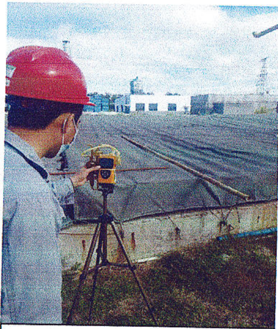
一号酸化池硫化氢检测
