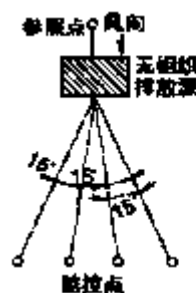
图 3-1-15 排放源上、下风向设置参照点与监控点示意图
