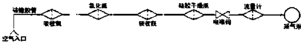
图 3-1-5 NO x 连续自动采样系统示意图
